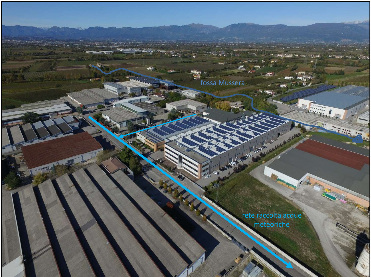
Figura 2.2: Area d'intervento con evidenziazione dell'alveo e direzione di flusso della Fossa Mussera e della rete di raccolta acque meteoriche comunali (Foto con drone - maggio 2017).
