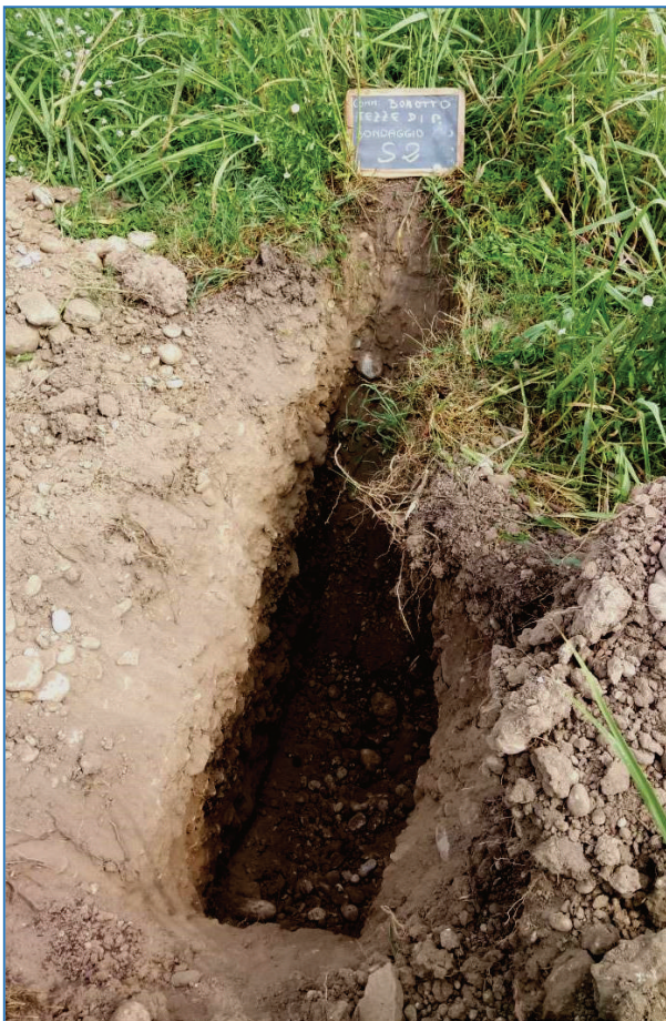
Fotografia 2 - Trincea geognostica S2
