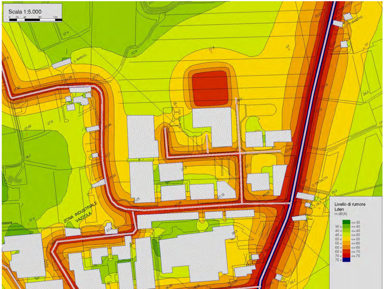
Figura 10.2: Stralcio mappa isofonica (a 4M.) – Cantiere Attivo – 06:00 – 22:00
