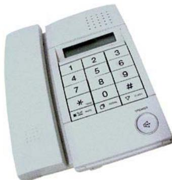
Figura 6 – Dispositivo per la trasmissione dell'allarme incendio
