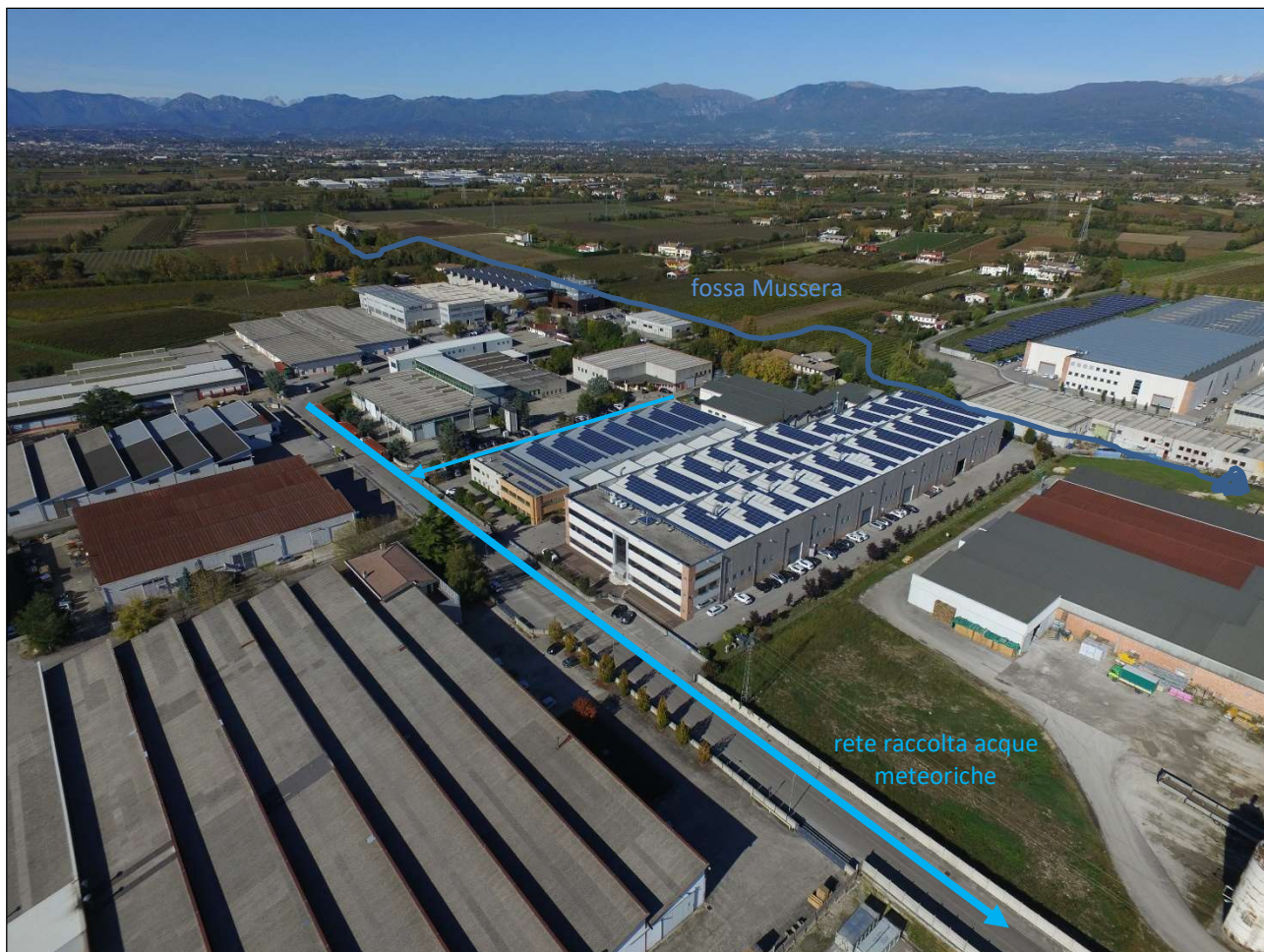
Figura 1.2: Area d'intervento con evidenziazione dell'alveo e direzione di flusso della Fossa Mussera e della rete di raccolta acque meteoriche comunali (Foto con drone - maggio 2017).
