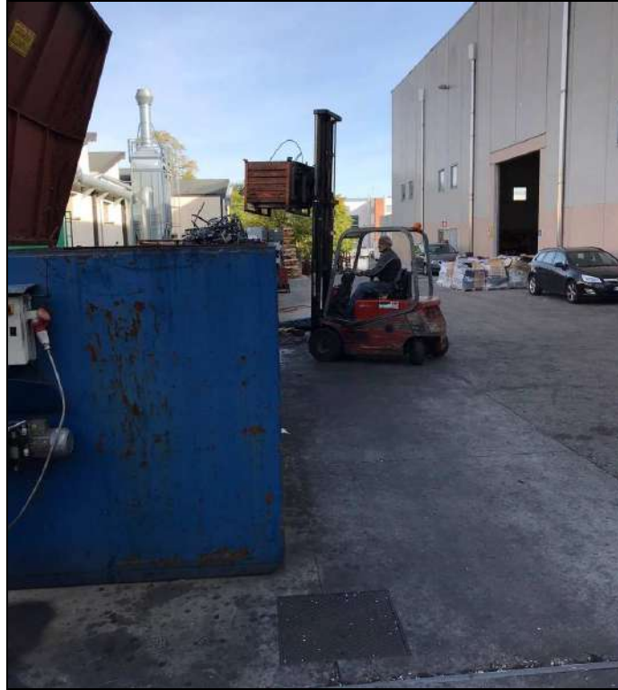
Figura 9 - Scarico entro cassoni degli sfridi metallici delle lavorazioni
