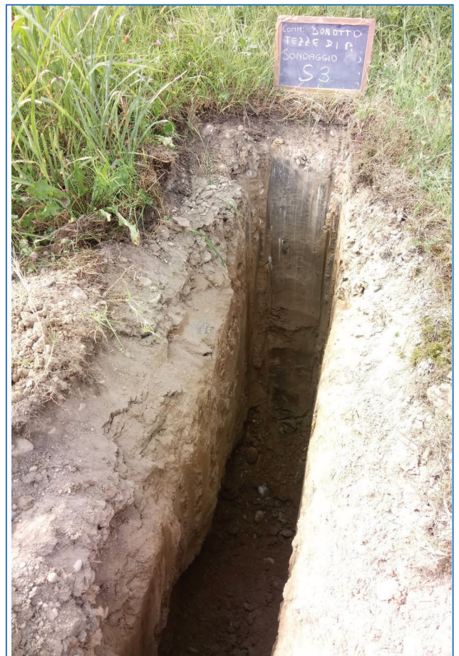
Fotografia 3 - Trincea geognostica S3
